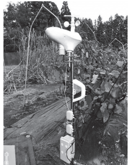
センサー 栃木県茂木町にて設置している土壌センサーと簡易気象計（ベジタリア製）＝2018年10月、日本総研撮影
