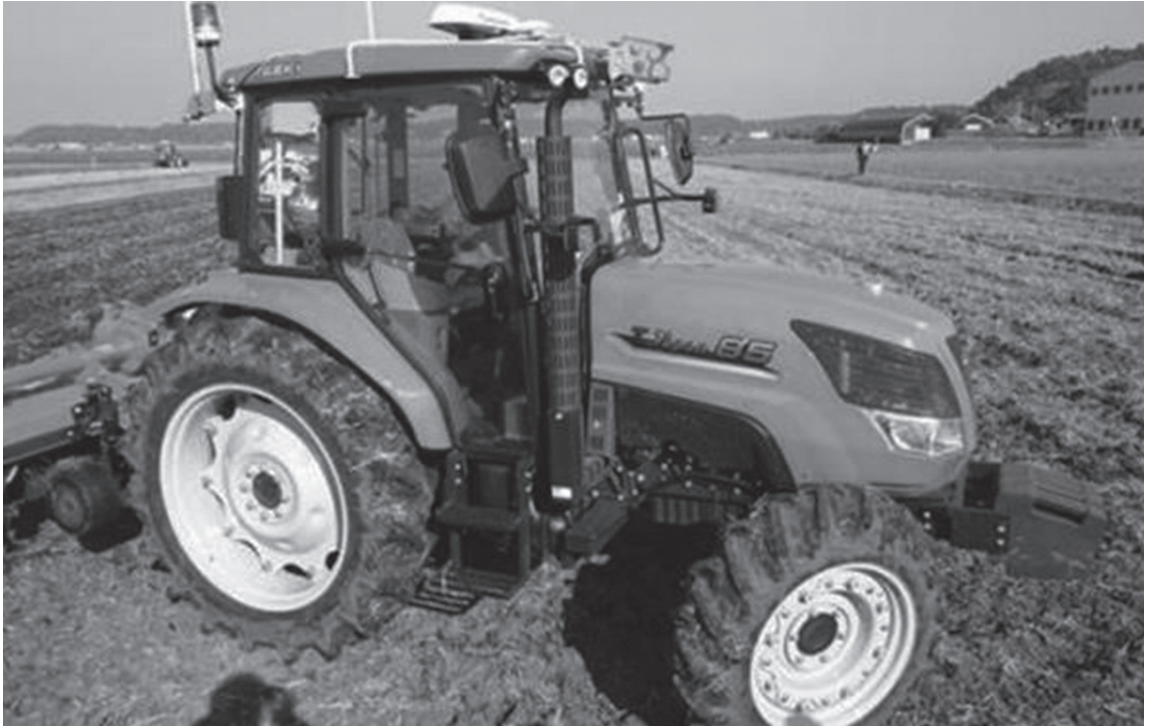
自動運転トラクター 内閣府「SIP 次世代農林水産業創造技術」での自動運転トラクターの実証事業の様子。オペレーターが手前と奥の2台のトラクターを同時に操作している=2017年、日本総研撮影
