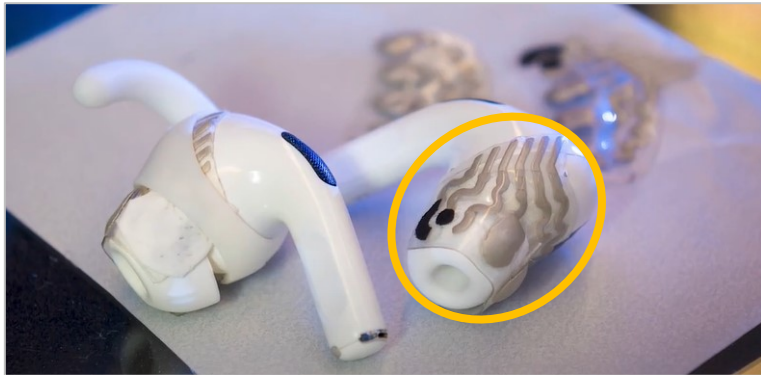
図:イヤホンに貼り付けられた非侵襲型センサー
